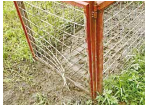
▲内側から破壊された箱わなイノシシの力はすさまじく、溶接された檻も壊して逃げていきます。
